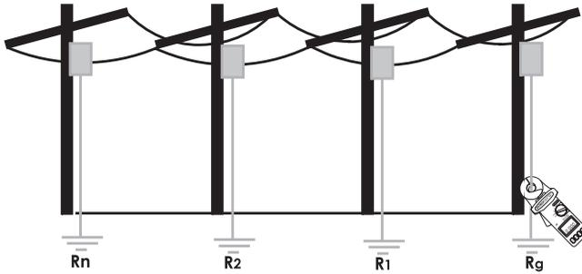
Si las resistencias de tierra paralelas  $R_1, R_2, R_3$ , etc, hasta  $R_n$  son combinadas como  $R_{eq}$ , luego solo  $R_g$  y  $R_{eq}$  quedan en el circuito
