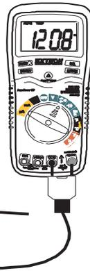
**NOTA:** La sonda para temperatura está equipada con un mini conector tipo K. Se suministra un adaptador de mini conector, a conector tipo banana para conectarse a los conectores tipo "jack" de entrada.
