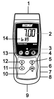
**Hinweise:** Die Elemente 6, 7, und 8 befinden sich hinter der aufklappbaren Abdeckung auf der rechten Seite des Messgeräts.
