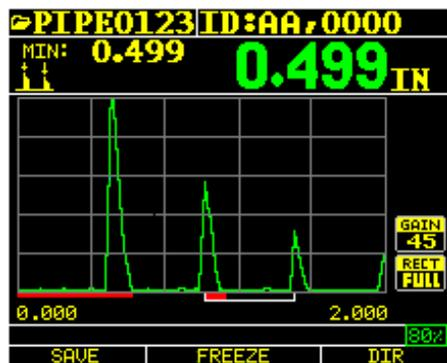
Forma d'onda a colori in Echo-to-Echo, nome del file, ID, minimo, valore di spessore grande, Echo-to-Echo, gamma, echi, vuoto, guadagno, rettifica, durata della batteria, salvataggio, blocco e directory.
