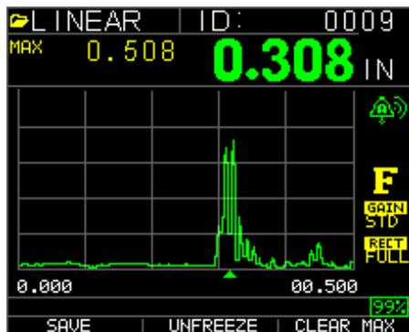
**Nota:** l'indicatore LOS mostra il valore LAST MAX o LAST MIN e viene mostrato in base all'impostazione *FastMax* o *FastMin*.
