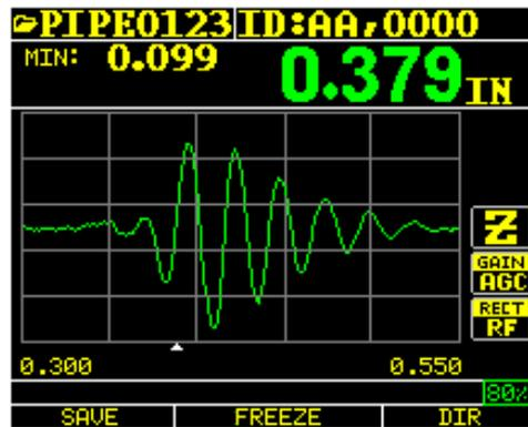
Sinal RF com cursor lado superior inferior "V" indicando onde a medição está sendo realizada
