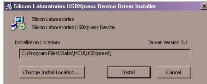
Um den Treiber manuell zu installieren, stecken Sie den VB300 in einen freien USB-Anschluss des PCs. Handelt es sich um den Erstanschluss des VB300 an der speziellen PC-Schnittstelle, erscheint folgender Bildschirm:
