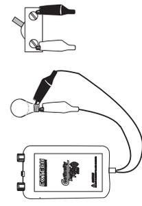
1. Zet de stroom aan. De groene stroom-LED zal branden. Als de groene LED niet oplicht, vervang dan de batterij van 9V.
