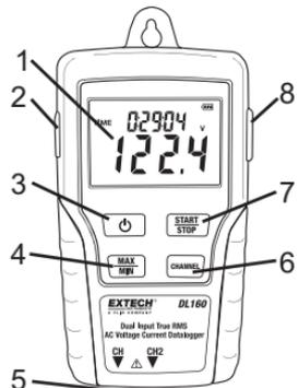
7. **START/STOP:** Nachdem der Datenlogger durch die Software eingestellt wurde drücken Sie die START/STOP Taste für 4 Sekunden, um mit der Aufnahme zu beginnen. Drücken Sie die Taste nochmals für 4 Sekunden, um die Aufnahme zu beenden. Die Aufnahme kann nicht wieder begonnen werden, bis die Daten an die Software übermittelt wurden.
