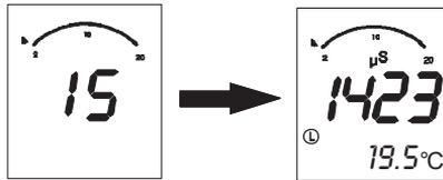
2. Die zuletzt gespeicherte Messung wird zuerst angezeigt. Durch Betätigen und Loslassen der Taste **MODE/HOLD** durchläuft man die gespeicherten Messungen eine nach der anderen. Zunächst wird die Speicherplatznummer angezeigt, gefolgt von der darin gespeicherten Messung.
