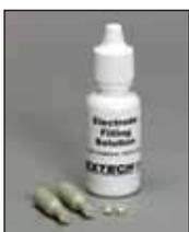
**Modelo PH113 Kit de solución de recarga incluye botella con 1.5mL de KCl, 2 uniones de referencia y 2 herramientas.**
