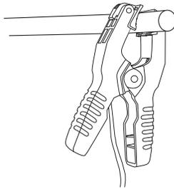
**Remarque :** Pour obtenir les meilleurs résultats, la surface de contact doit être exempte de saleté ou de toute substance susceptible d'inhiber le contact thermique.
