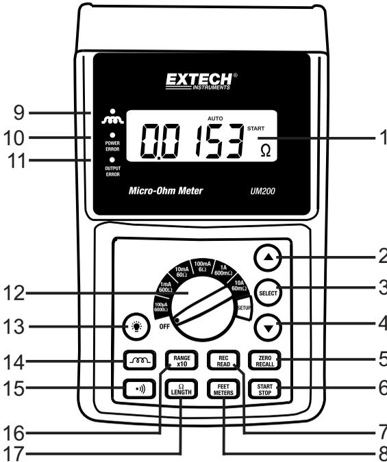
1. **LCD:** LCD mit 6000 Zählerständen und Hintergrundbeleuchtung.
